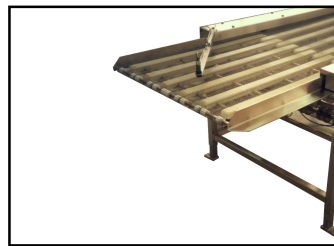
Teleskopgaffel, pneumatisk med fasta lägen. Rörelsen är ställbar i längd och hastighet.
